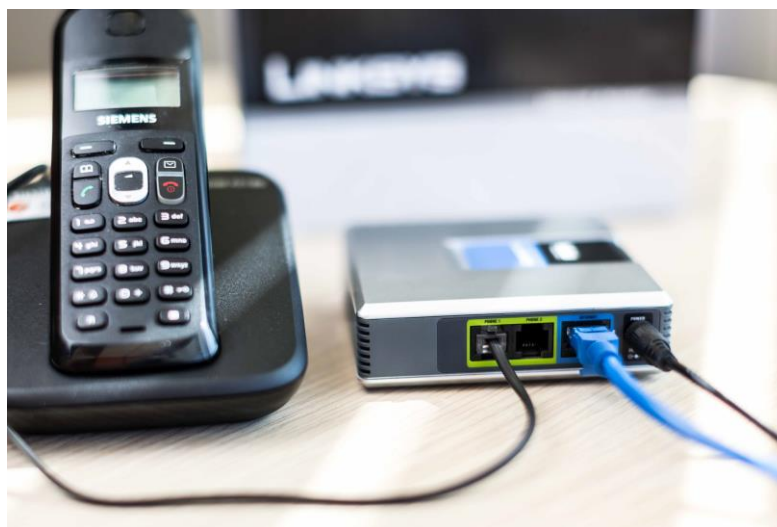
SLIKA6: telefonski aparat priključen na PHONE1
